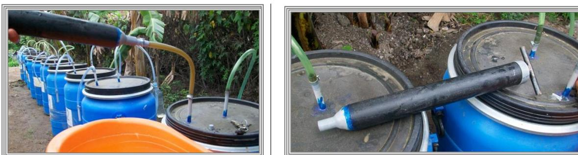
**Figura 5: Extracción de muestras de biol utilizando herramienta de succión.**
