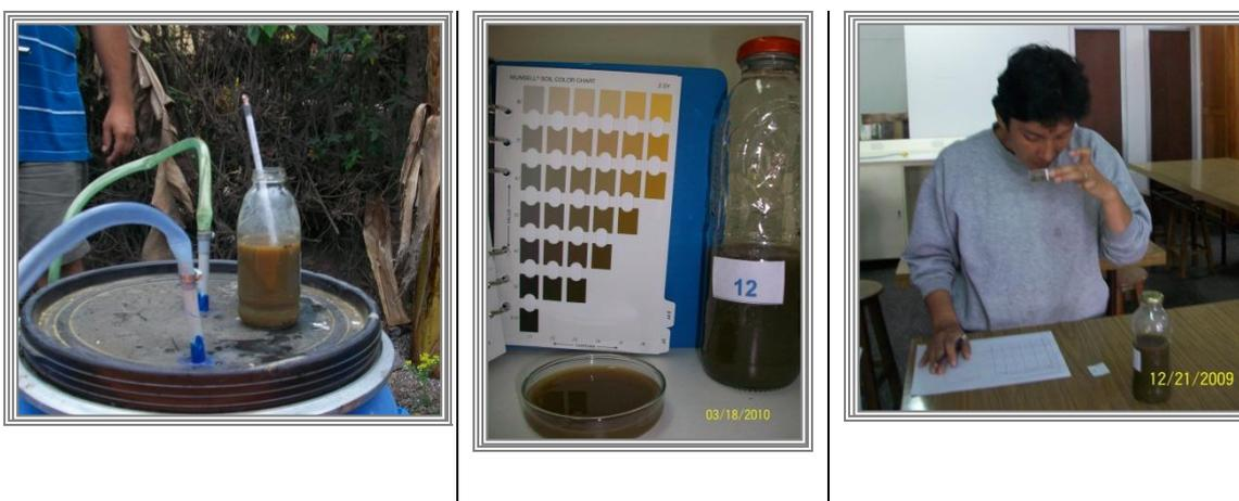
**Figura 6: Determinación de temperatura (izquierda), color (centro) y olor (derecha) durante el proceso de elaboración.**
