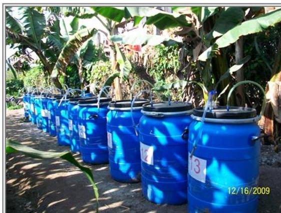
**Figura 4: Disposición final de los biodigestores durante el proceso de elaboración de bioles**
