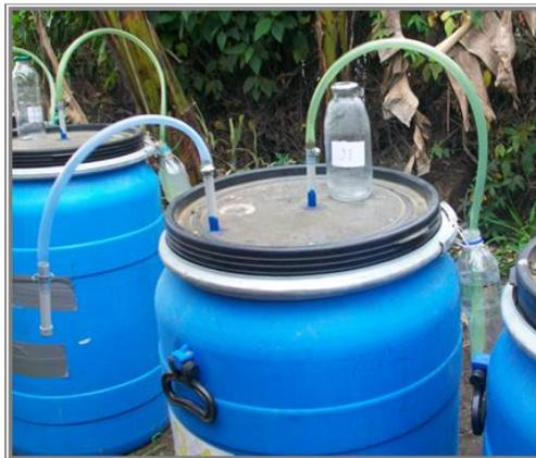
**Figura 2: Modelo de biodigestor artesanal construido para la investigación**
