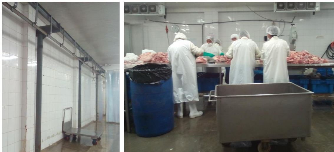
Figura 5: Izquierda: rielería en sala de desposte. Derecha: Operación de desposte.
