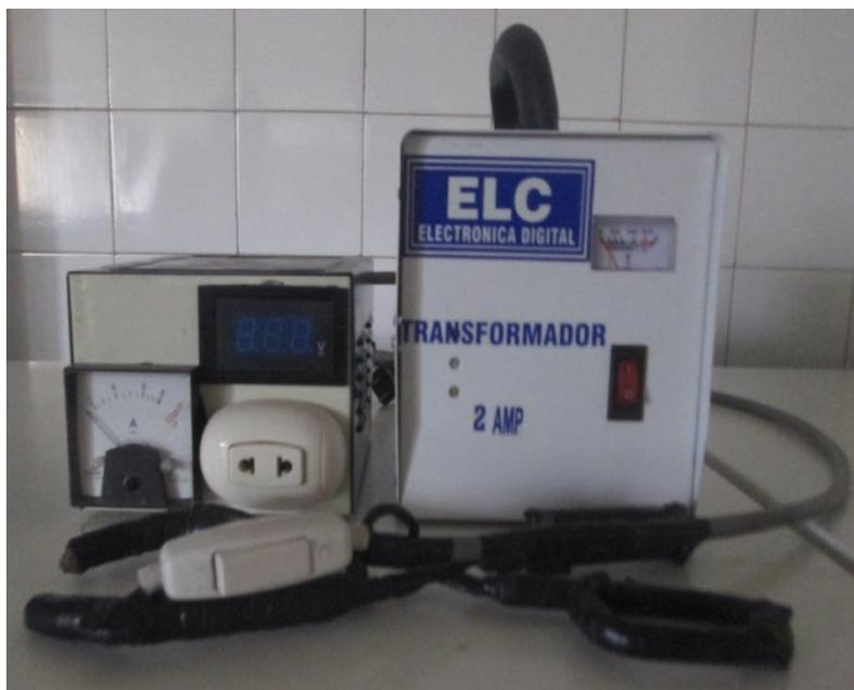
**Figura 6. Equipo de aturdidor eléctrico: voltímetro, pinza, amperímetro y transformador.**
