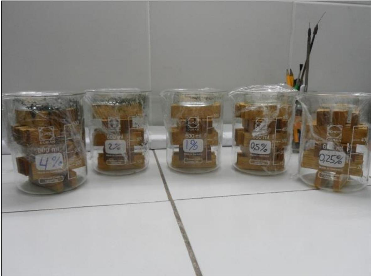
**Figura 11** Probetas inoculadas con el biocontrolador, bajo almacenamiento.
