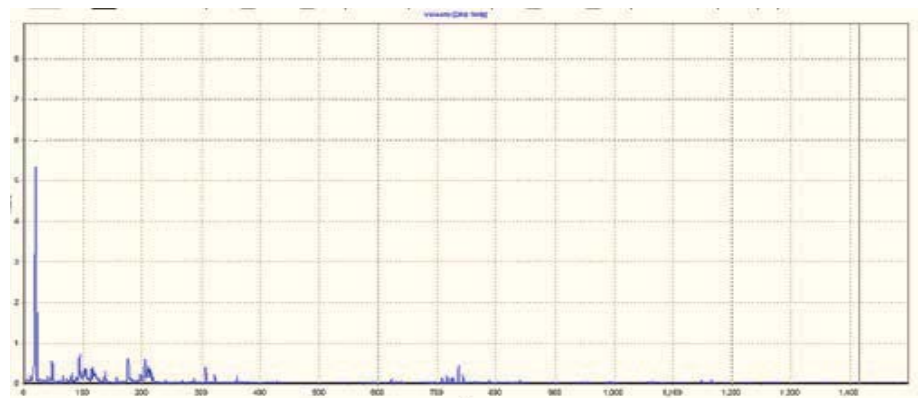
Gráfico.6. Espectro de punto horizontal del motor
