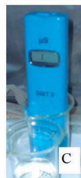
Figura 4 Conductividad 2831éctrica A. Vaso de precipitado B y C. Conductímetro.
