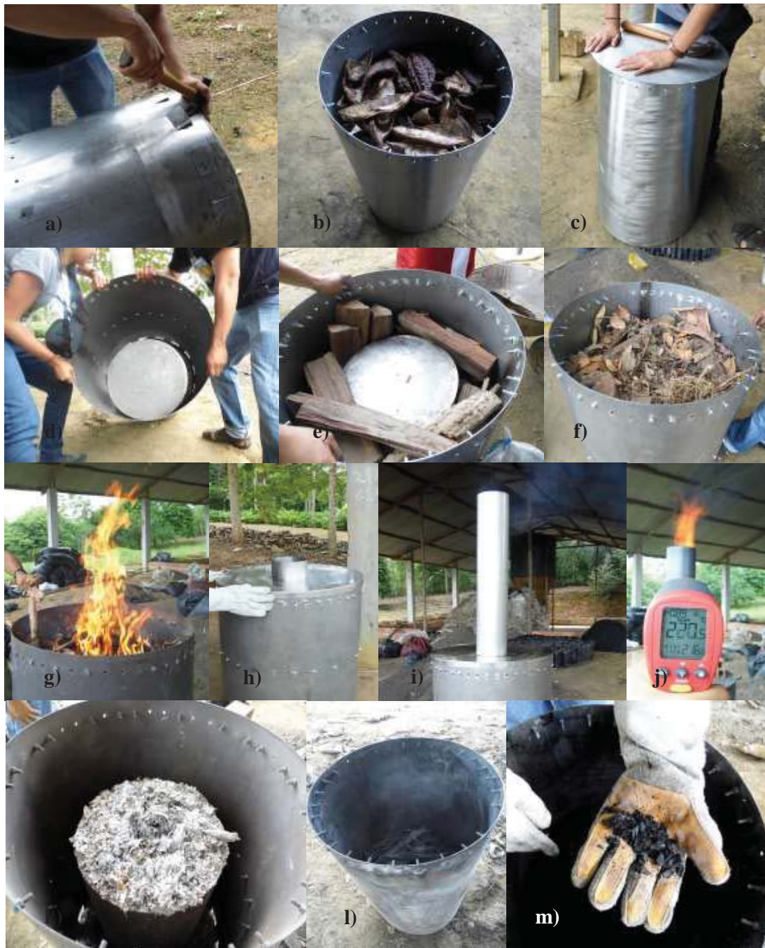
Figura 8: Producción de biochar. a) Acondicionamiento de las entradas de aire del tambor externo. b) Llenado de la cámara interna con la biomasa seca. c) Cierre de la cámara interna. d) Ubicación de la cámara interna dentro de la cámara externa. e) y f) Acondicionamiento con leña y hojarasca en el espacio libre comprendido entre las dos cámaras. g) Inicio de la llama. h) Cierre del dispositivo. i) Inicio del proceso de pirolisis. j) Monitoreo de la temperatura. k) Cese de la producción de biochar. l) Extracción de la cámara interna. m) Biochar fácil de moler.
