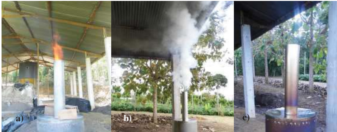
Figura 10: Control de humo en el proceso de pirólisis. a) Inicio del fuego. b) liberación del contenido de humedad y de otros gases. c) liberación de flama azul.
