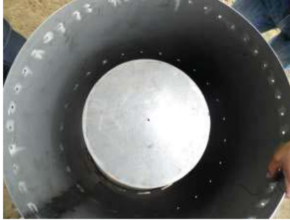
Figura 7: Vista en planta de los dos tambores del horno pirolítico. Fuente: propia.
