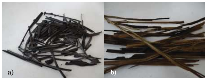
Figura 21: Nivel de pirolisis del biochar de la hoja de palma aceitera. a) Total. b) Ligeramente
