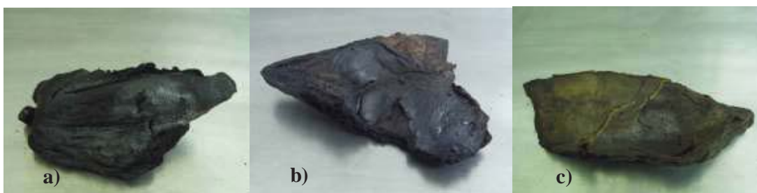
Figura 19: Nivel de pirólisis del biochar de cáscara de cacao. a) Total. b) Parcial. c) Ligero.
