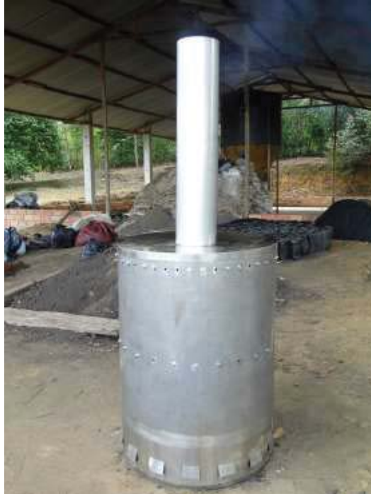
Figura 6: Horno pirolítico de doble tambor para la producción de pirolisis lenta de biochar. Fuente: propia.
