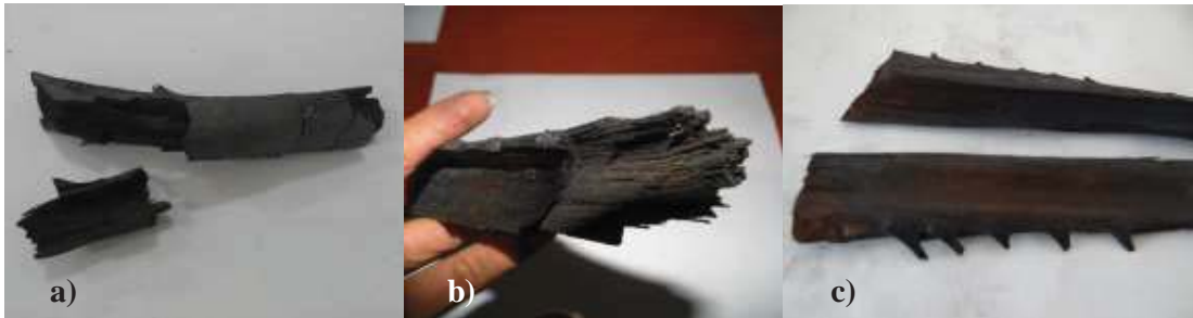
Figura 20: Nivel de pirolisis del biochar de peciolo de palma aceitera. a) Total. b) Parcial. c) Ligeramente
