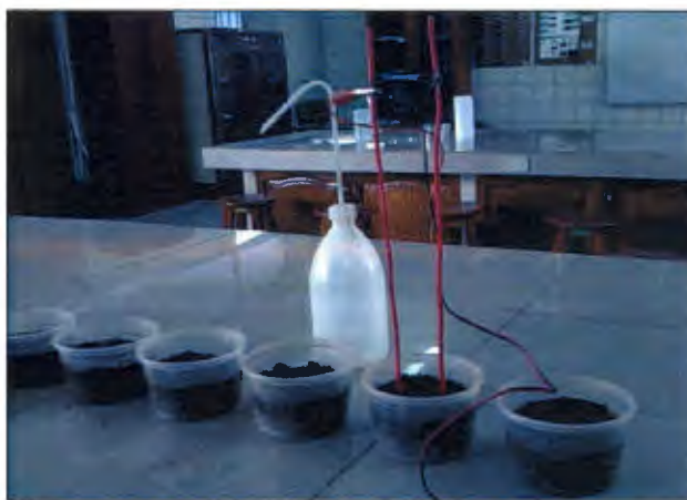
Figura N° 05: Calibración del sensor de humedad
