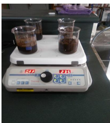
Figura 9: Colocación de muestras en el Agitador
