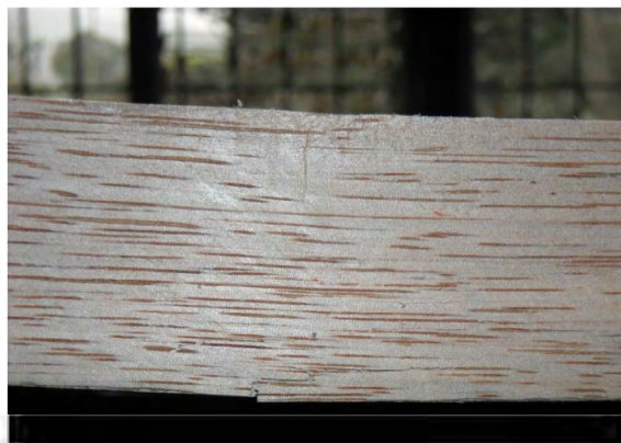
Figura 19 Fallas de compresión en flexión estática.
