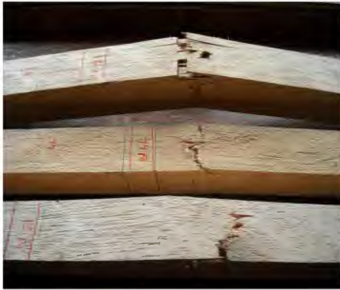
Figura 16 Fallas de Flexión de las probetas. Presencia de quebradura en diferentes grados.
