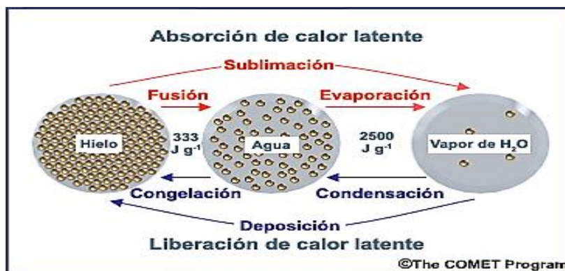
Figura 7. Las fases del agua y el intercambio de calor latente (Laing y Evans, 2011).
