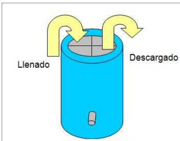
Figura N° 2: Biodigestor tipo Batch.
