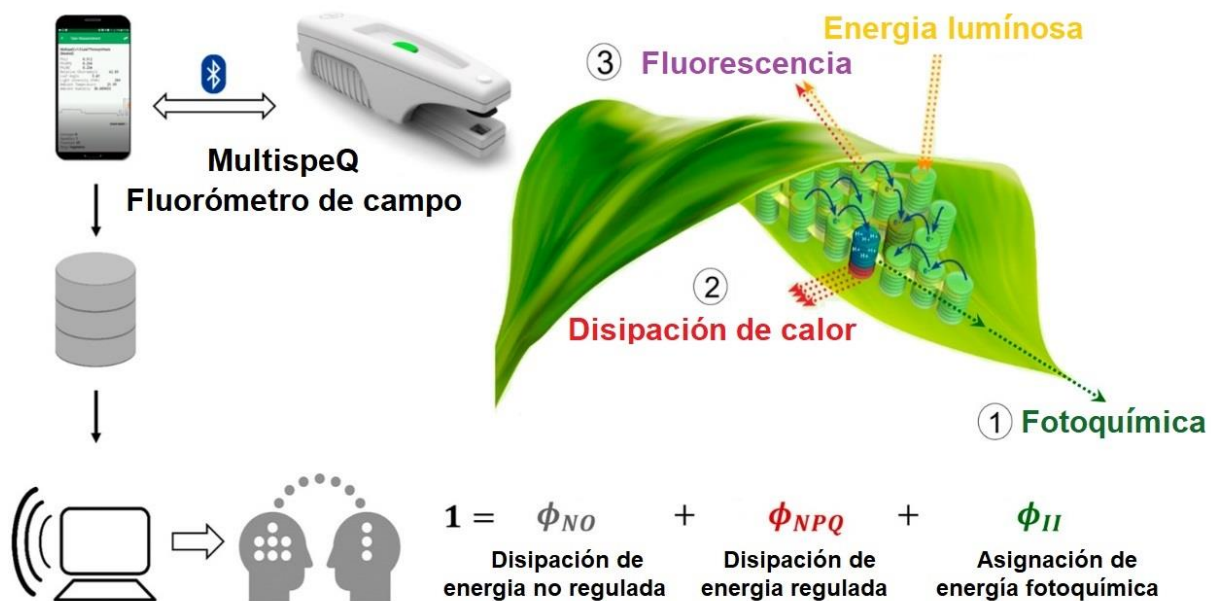
Figura 2. Equipo MultispeQ que mide la fluorescencia de la clorofila en respuesta a pulsos de saturación de luz
