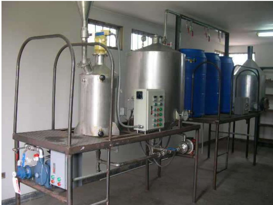
Figura 29: Planta de producción de Biodiesel de 240 lits/batch. Esta planta fue auspiciada por CONCYTEC, y sirve actualmente para hacer diversas investigacion en este biocarburante
