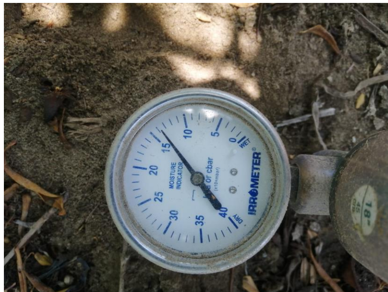
Figura 14. Medición de tensiómetro de 45 cm de profundidad
