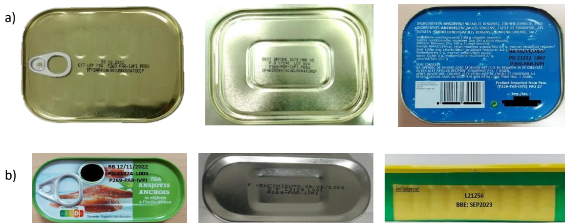
Figura 11. Diferente posición del codificado para envases metálicos (hojalata y aluminio)
