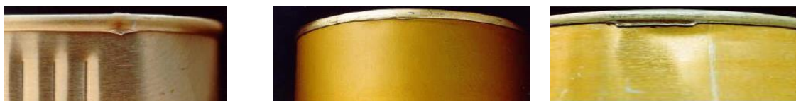
Figura 19. Ejemplos de defectos visuales del doble cierre
