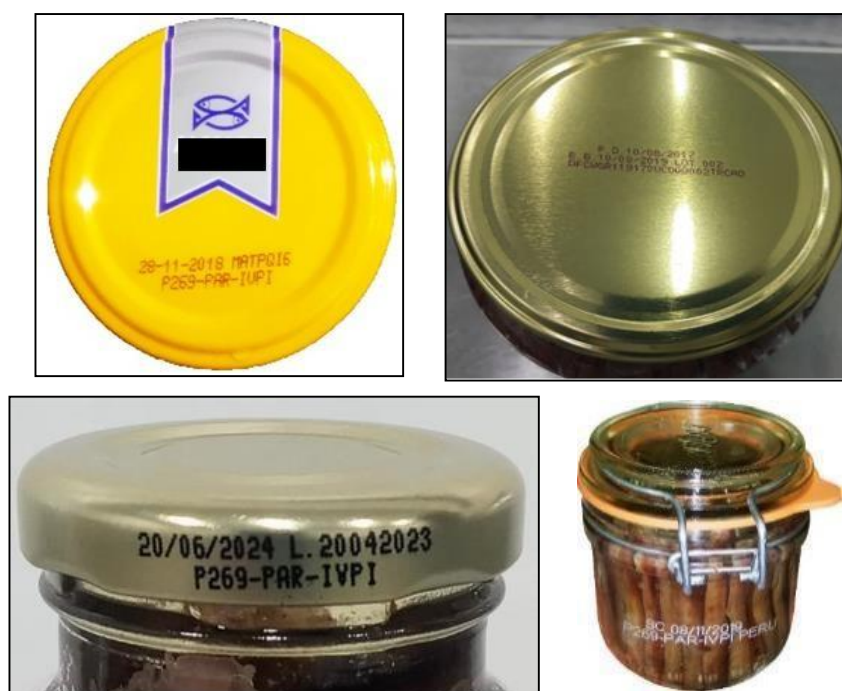
Figura 10. Diferente posición del codificado para envase de vidrio (frascos)
