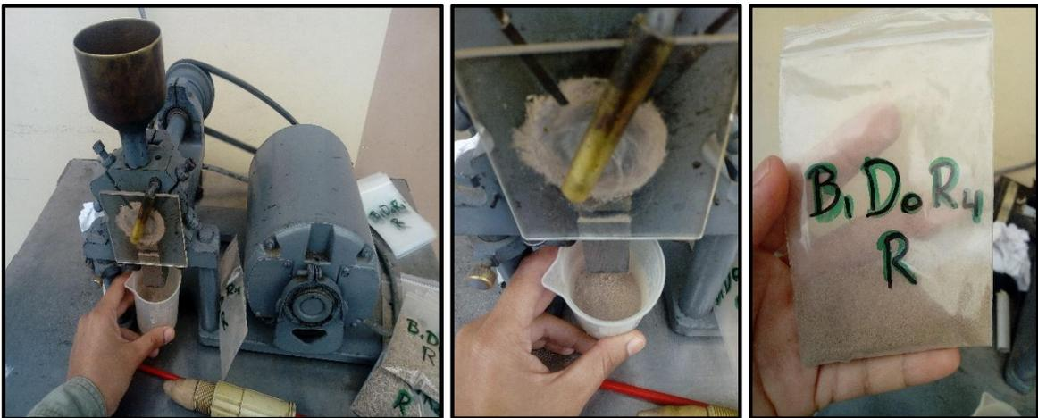
**g. Análisis en laboratorio: digestión seca para la obtención de alícuota para analizar cadmio mediante espectrofotometría de absorción atómica**
