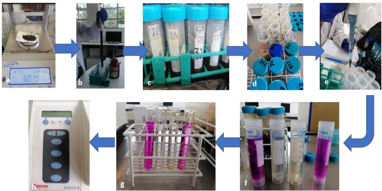
NOTA: Secuencia 06. a) Peso de las muestras. b) Añadimos la solución oxidante c) Sellar los tubos herméticamente y agitar. d) Agitar y destapar. e) Tomar alícuota de 0.5mL y vaciar en tubos con agua. f) Enrazar a 50 Ml. g) Verter una alícuota en la celda. h) Llevar al colorímetro y leer a 550 nm.
