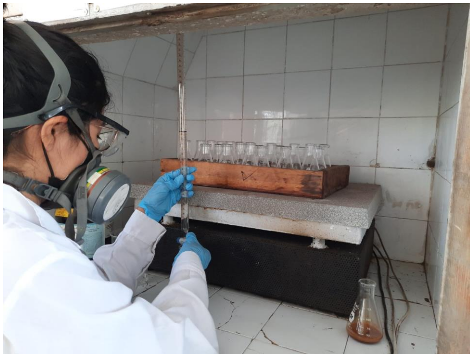
Anexo 30. Proceso de agregación de ácido nítrico perclórico a las muestras molidas
