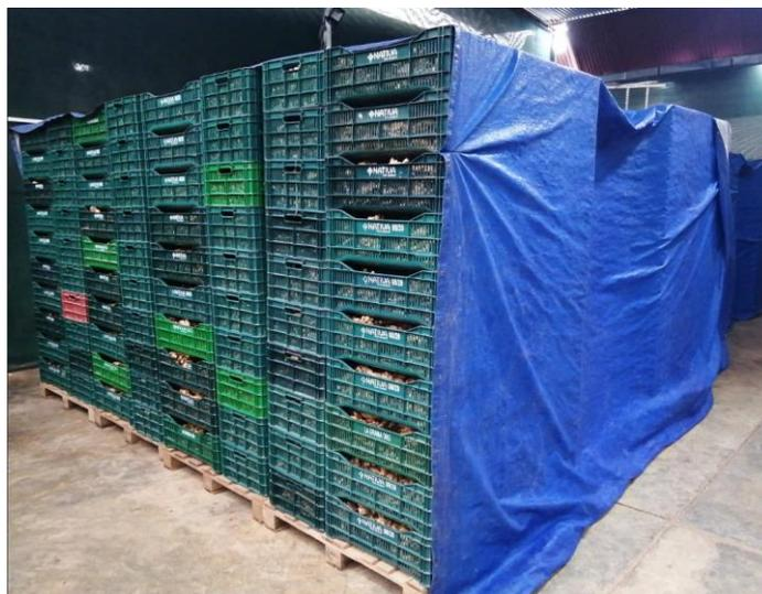
**Figura 16:** Túnel de secado formado por las jabas con el jengibre por secar
