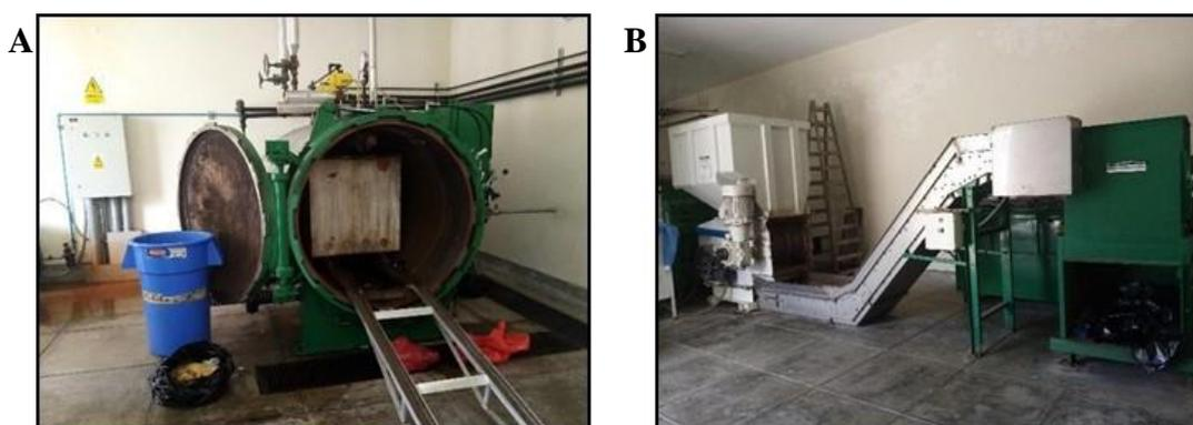
**Figura 18:** Fotos del proceso de tratamiento de residuos. A) Esterilizador; B) Equipo Triturador – Compactador.
