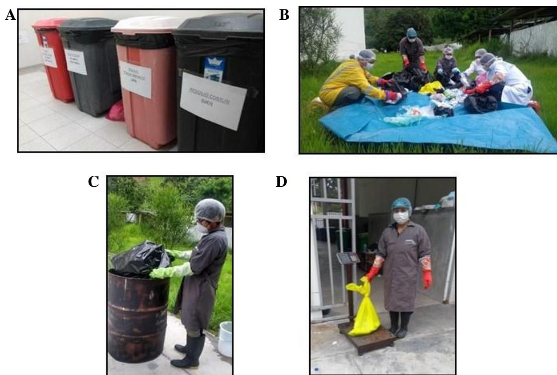
**Figura 39:** Fotos del trabajo de caracterización. A) Marcado de recipientes; B) Caracterización de residuos; C) Recipientes para medida de volumen; D) Balanza de pesaje.
