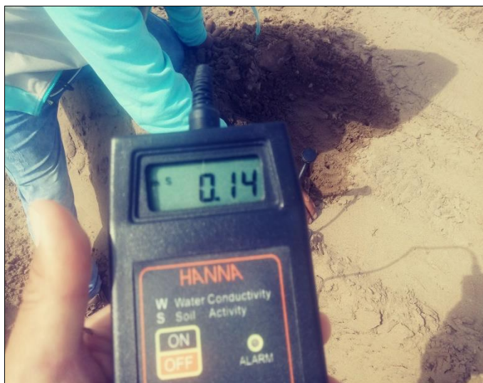
Figura 6: Lectura del conductímetro en el camellón después del lavado
