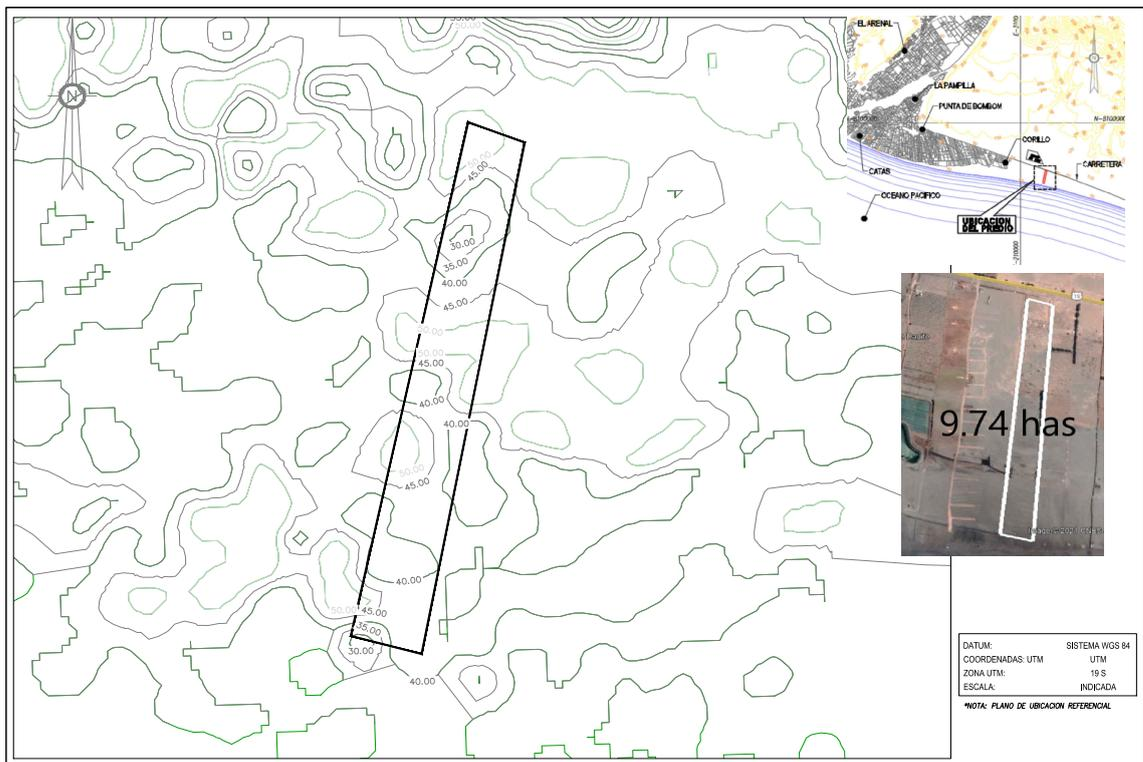
**Figura 9: Curvas de nivel en el terreno de la fase 1 – escala 1:5000**
