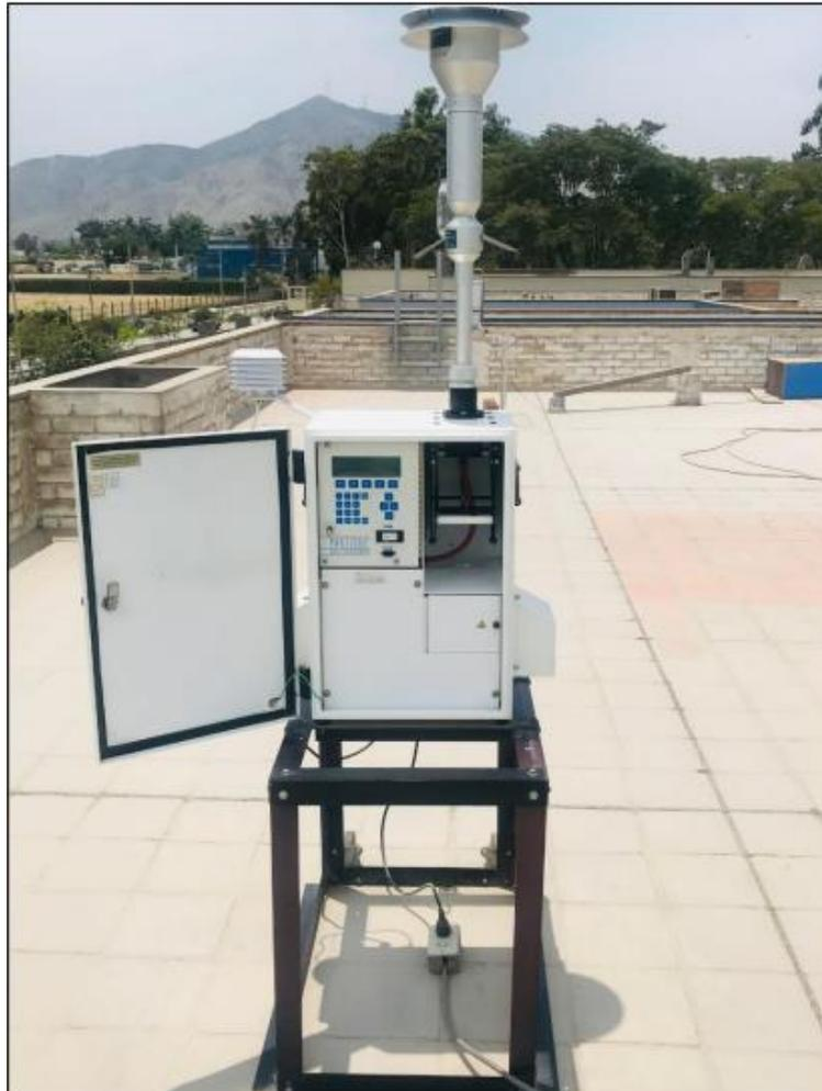
*Figura 7.* Equipo muestreador de bajo volumen – Partisol 2000H. Adaptado de “Comparación entre tres muestreadores de material particulado ( $PM_{2.5}$ ) en el campus de la UNALM” por G. Castelar, 2019, tesis de pregrado, p. 28.
