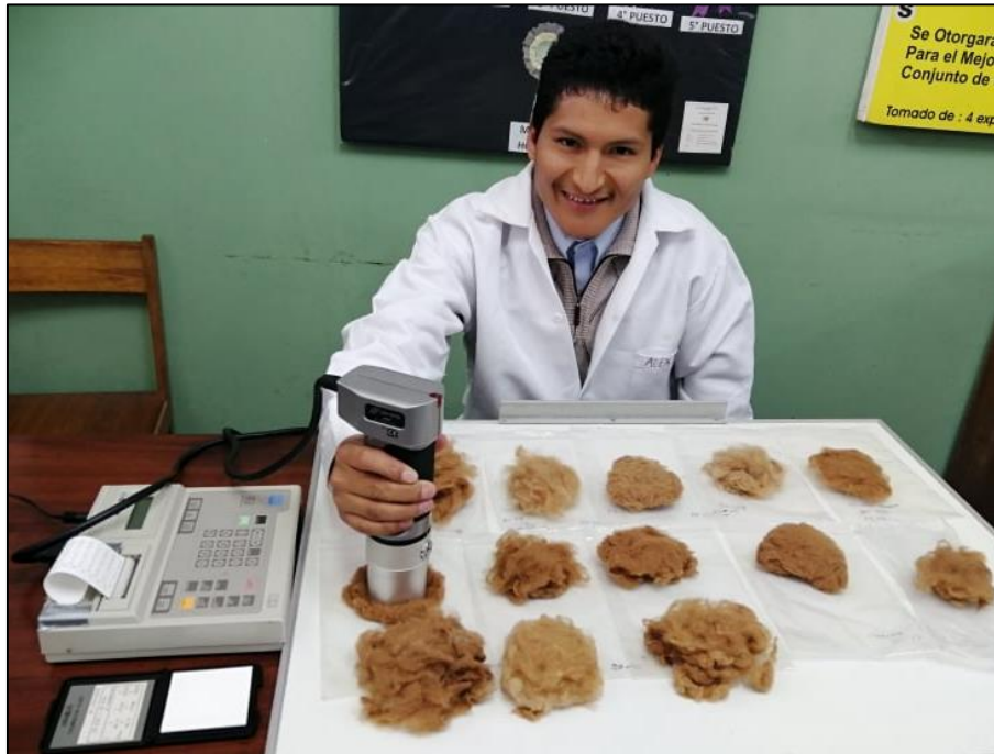
Figura 13: Cuantificación del color de fibra con el equipo Chroma Meter CR - 210
