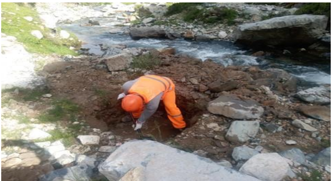
Figura 13: Toma de muestra de suelos a través de calicata
