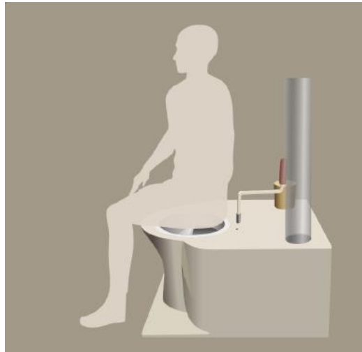
Figura 37: El sentado correcto en el inodoro asegura la separación orina y heces
