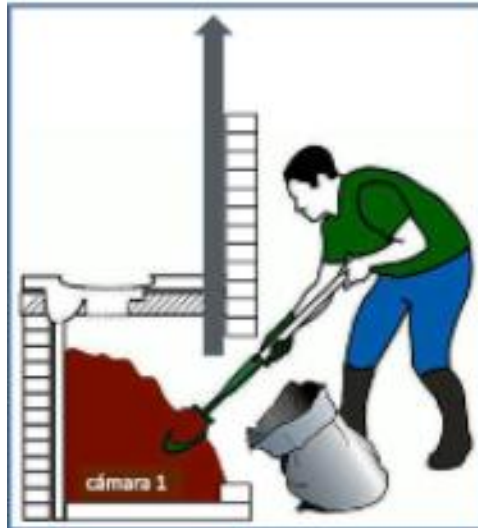
Figura 36: Descarga de la primera carga luego de un año de reposo
