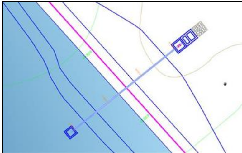
Figura 3: Toma de agua
