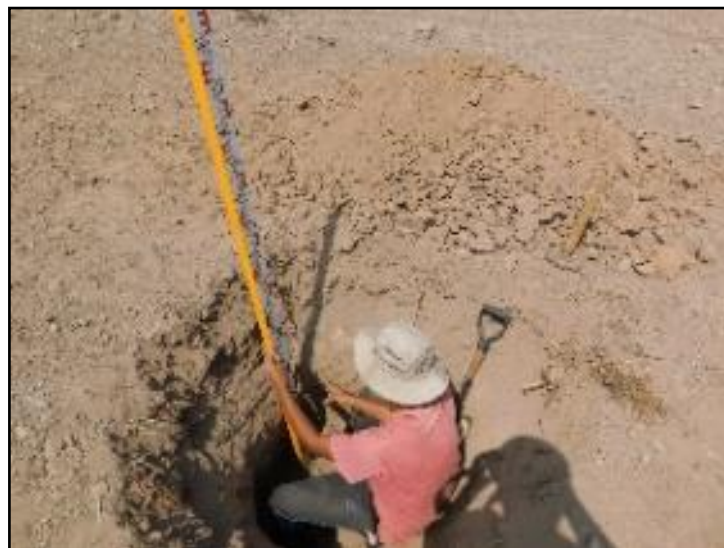
Figura 45: Identificación de la capa de suelo a muestrear
