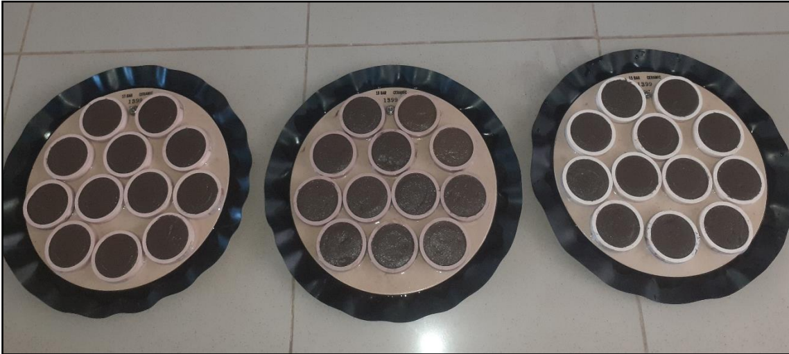
Figura 26: Platos y muestras saturadas para ser llevados a la cámara de alta presión
