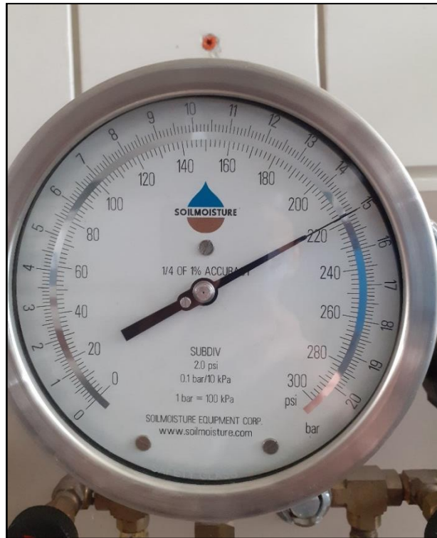
Figura 27: Presión a 15 bar correspondiente a humedad a punto de marchitez
