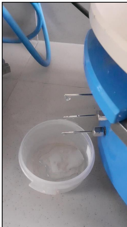
Figura 59: Salida de agua de la Olla de Richards (Cámara de alta presión)
