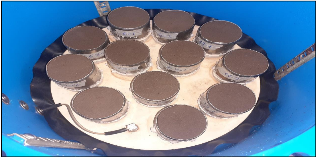
Figura 48: Muestras de suelo listas para ser llevadas al horno
