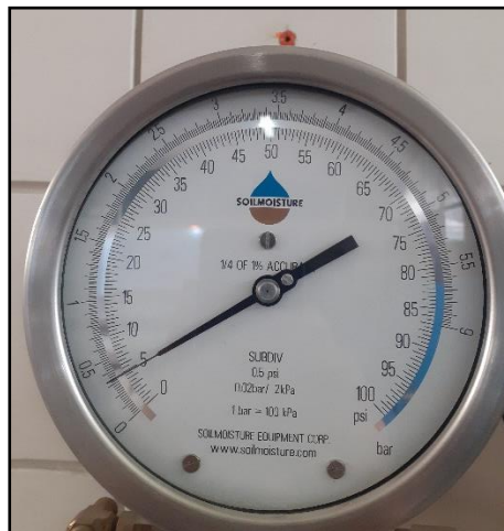
Figura 20: Presión a 0.33 bar para Capacidad de campo
