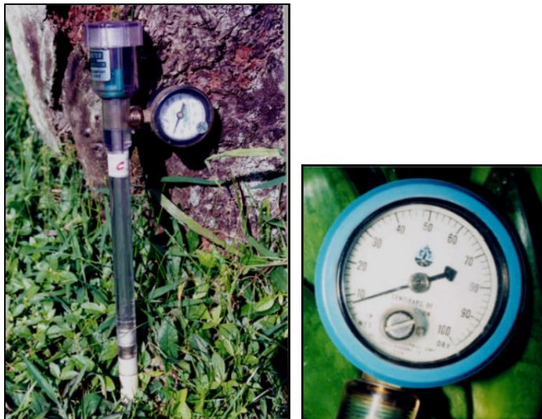
Figura 3: Tensiómetro con vacuómetro (unidades en centibares)
