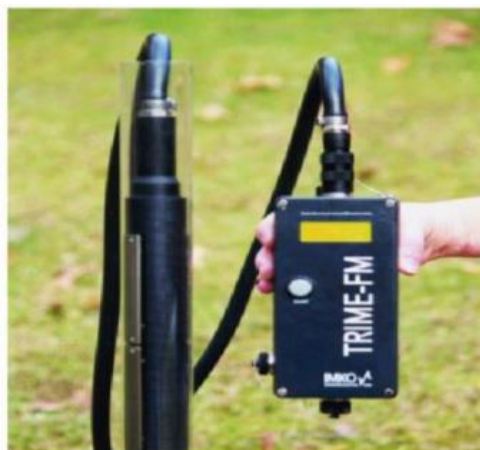
Figura 2: Equipo de TDR en campo
