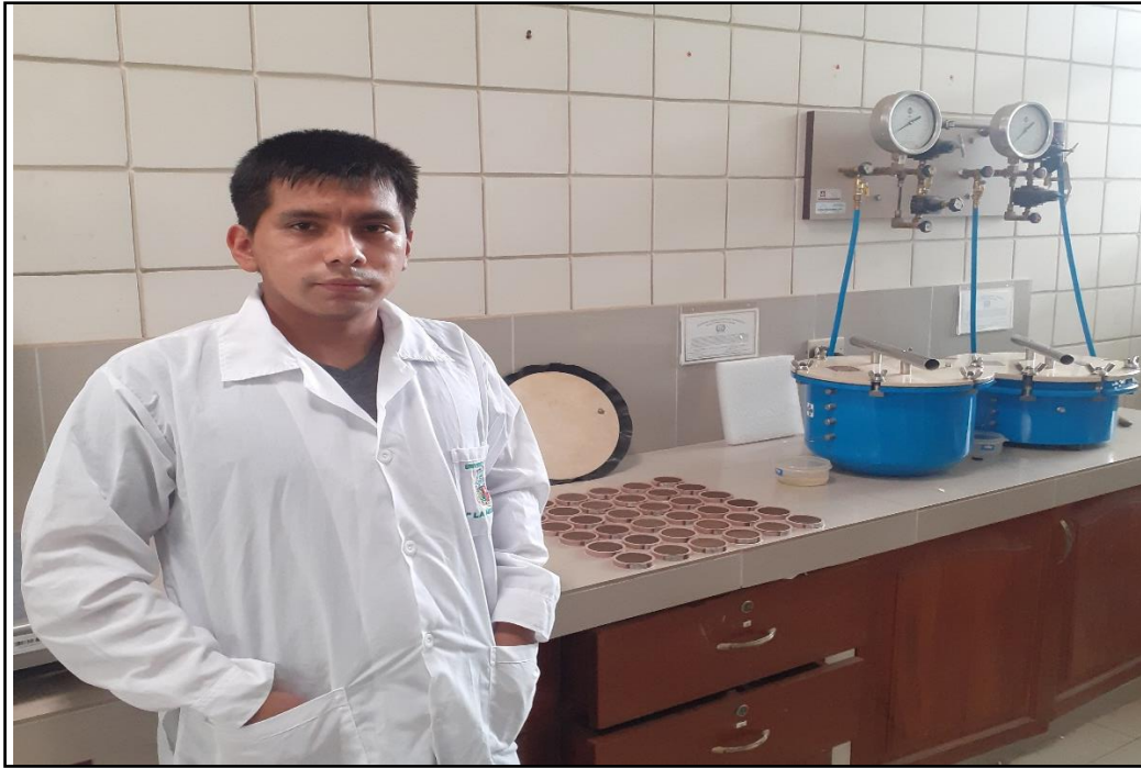
Figura 52: Presentación de las muestras de suelo y la Olla de Richards
