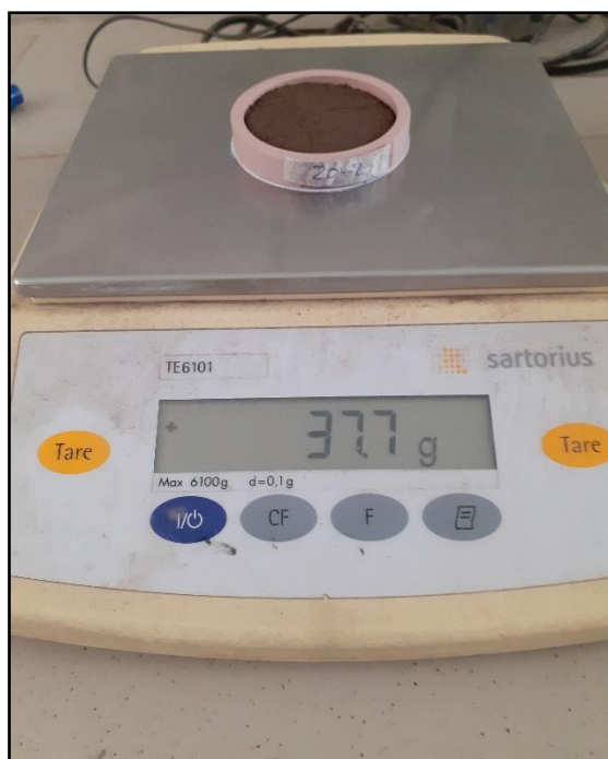
Figura 31: Pesado de las muestras de suelo
