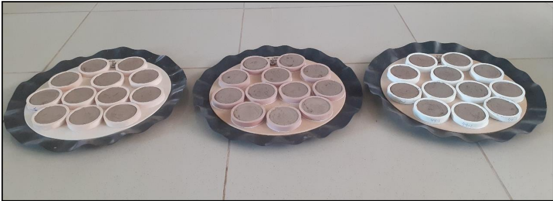
Figura 24: Suelo puesto en los anillos el plato de cerámica
