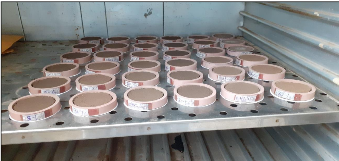
Figura 30: Muestras de suelo puestas en el horno
