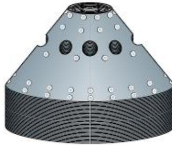
**Figura 18: Platos de distribución de un separador centrífugo**
