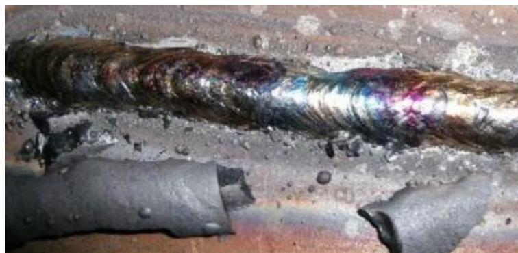
**Figura 57: Costra de soldadura interna formada por mala soldadura del acero**
