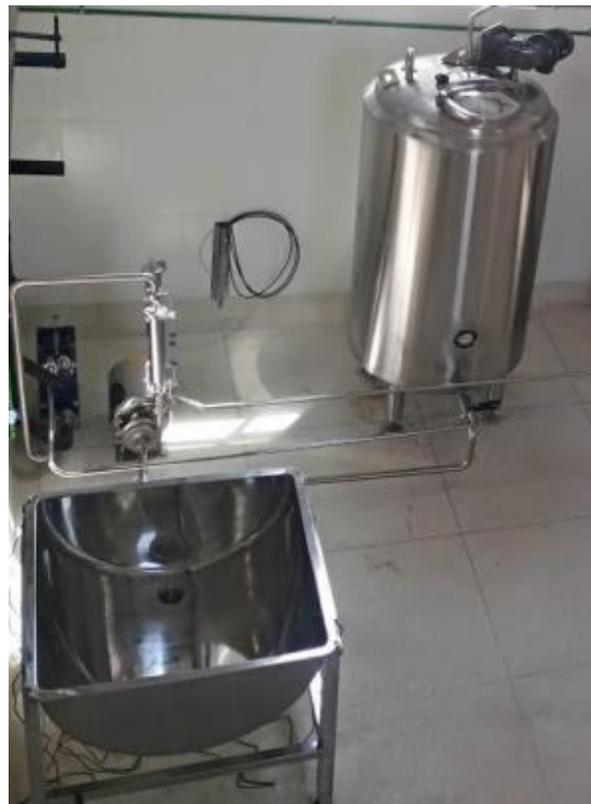
**Figura 66: Tina de pesado, bomba de recepción, intercambiador de calor, filtros mellizos y tanque de recepción**
