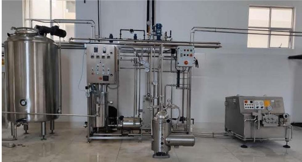
**Figura 67: Vista frontal del pasteurizador de leche fresca, separador centrífugo y homogenizador**
