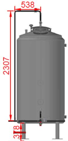
**Figura 52: Tanque de almacenamiento zona de envasado**
