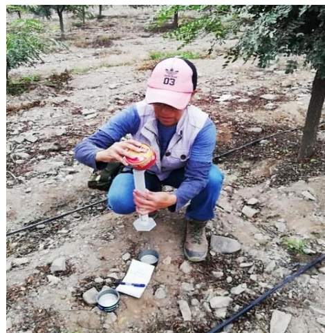
Figura 65: Procedimiento de la medición del CU
