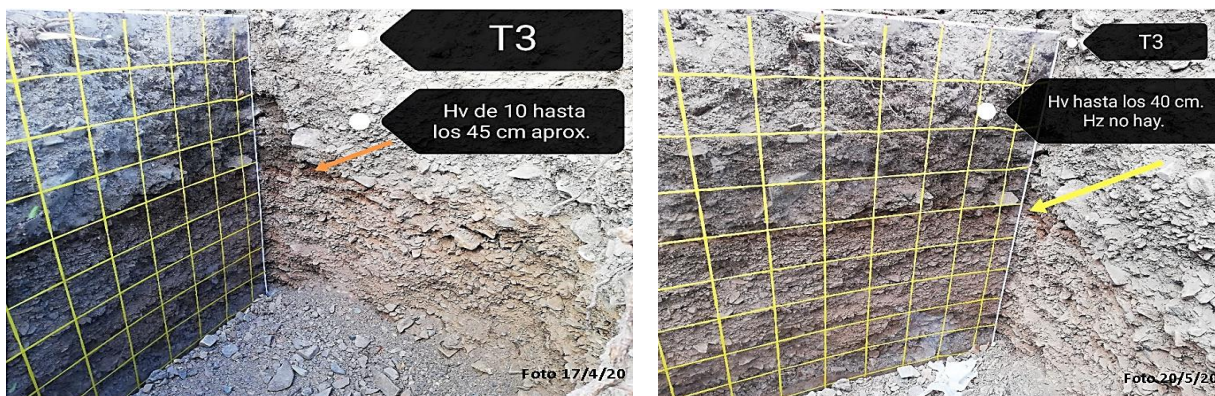
Figura 113: Rizotróf T3: Riego del 7 de abril y 20 de mayo, humedad entre los 40 y 45 cm de profundidad
