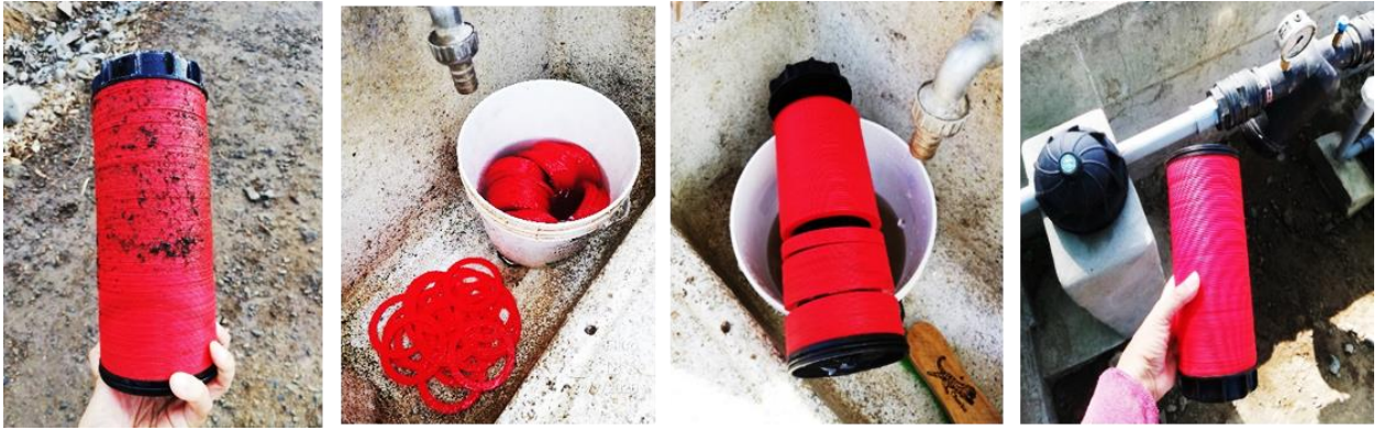
Figura 60: Secuencia del lavado del filtro de anillos
