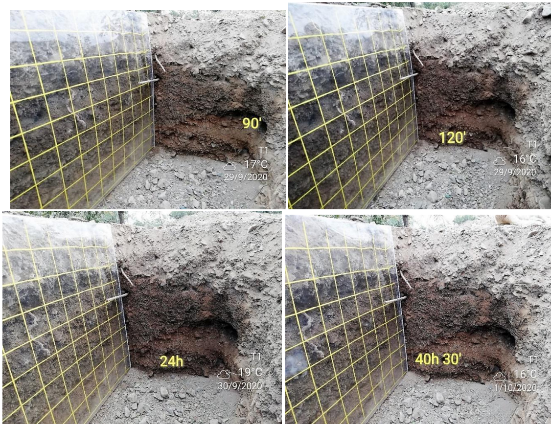
Figura 111: Rizotrón T1: Riego del 29 de setiembre, secuencia de imágenes de la infiltración en las tres dimensiones (x, y, z) a través del tiempo
