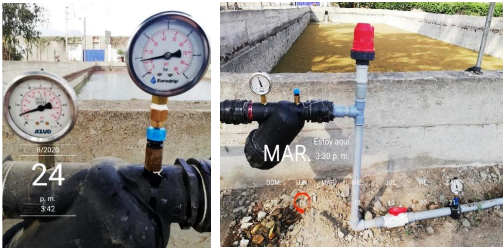
Figura 58: Medición de presión antes y después del filtro
