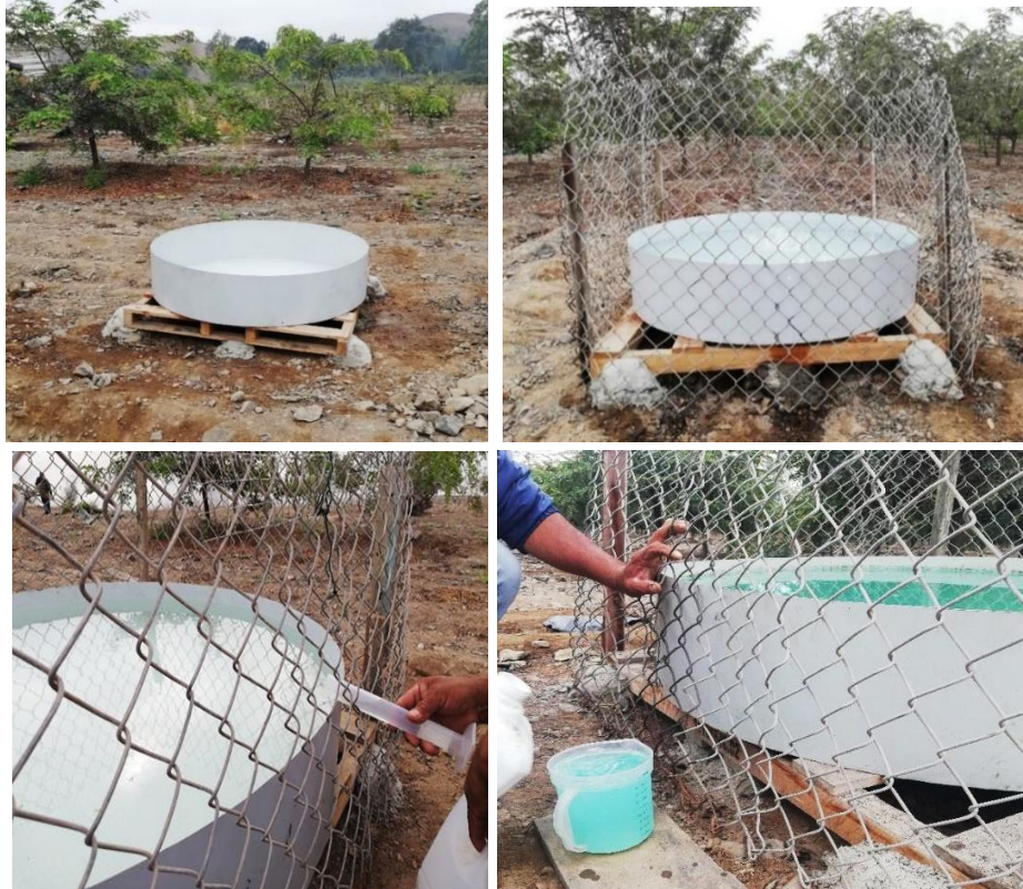
Figura 19: Instalación del tanque tipo A en el área experimental
