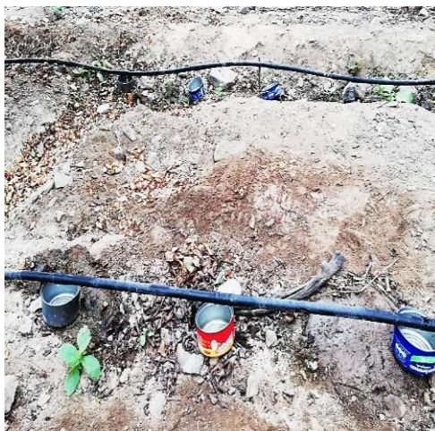
Figura 65: Procedimiento de la medición del CU
