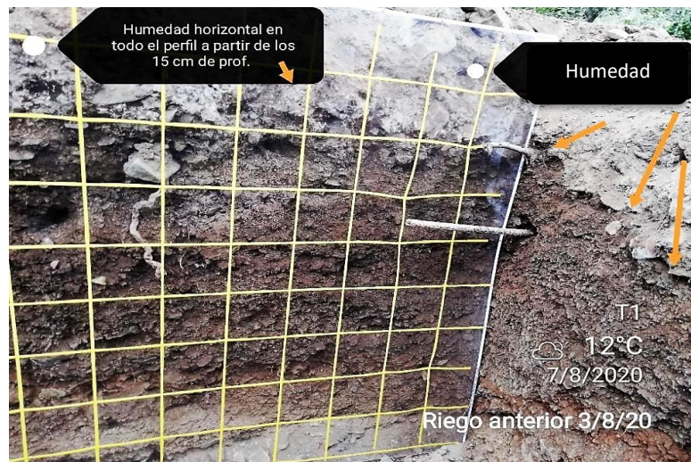
Figura 109: Rizotróf T1: Riego del 3 de agosto, imagen de la infiltración en tres dimensiones (x, y, z) tomada después de cuatro días
