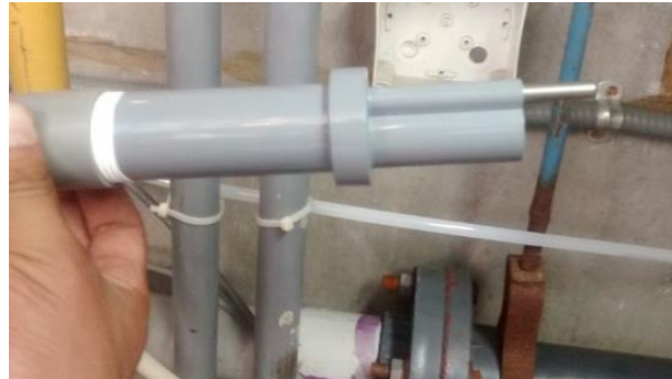
Figura 16: Sensor Industrial en Línea de pH con cubierta y preamplificador
