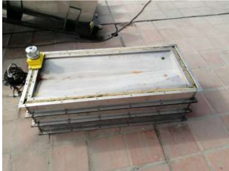
Figura 30: Fotografía mostrando 3 etapas desmontables del destilador
