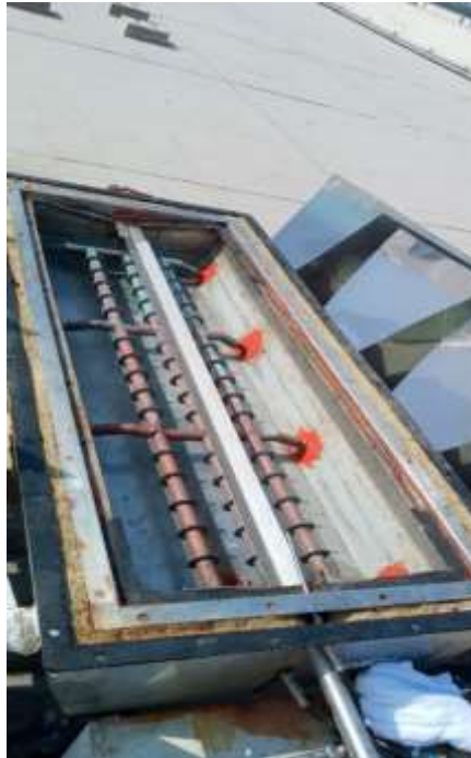
Figura 28: Fotografía mostrando la superficie extendida en la base del destilador
