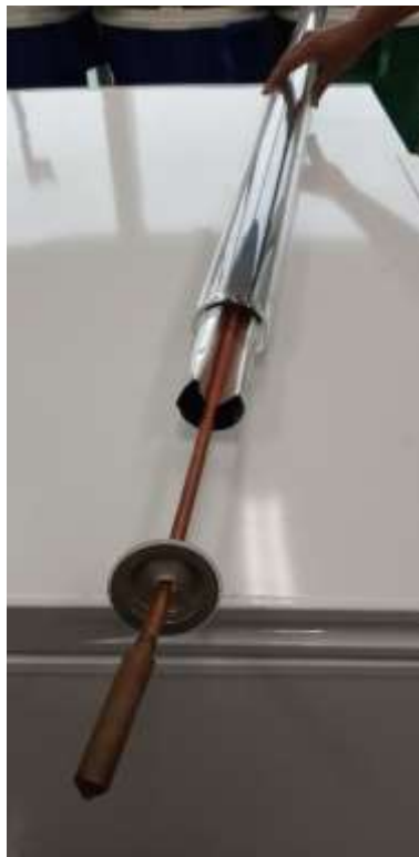
Figura 33: Fotografía de los tubos de vacío integrado con heat pipe
