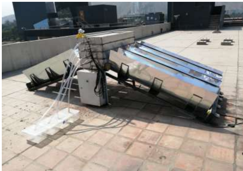
Figura 34: Fotografía del destilador solar de múltiples etapas acoplado a un colector solar de tubos de calor concentrado (CHPSC)
