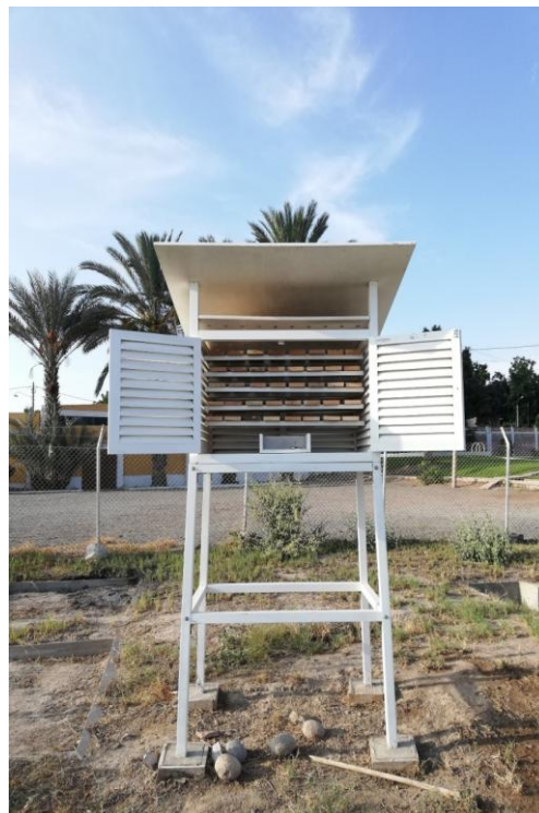
Figura 3. Instalación de casetas y puesta de probetas de madera
