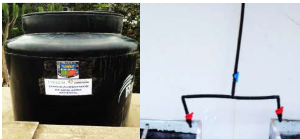
Figura 18: Abastecimiento del drenaje ácido artificial a los humedales.
