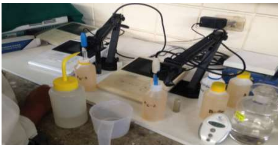
Figura 23: Medición del pH y Eh en el laboratorio.
