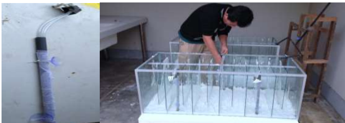
Figura 21: Instalación de accesorios en los puntos de muestreo en los compartimentos 3, 6 y 9.
