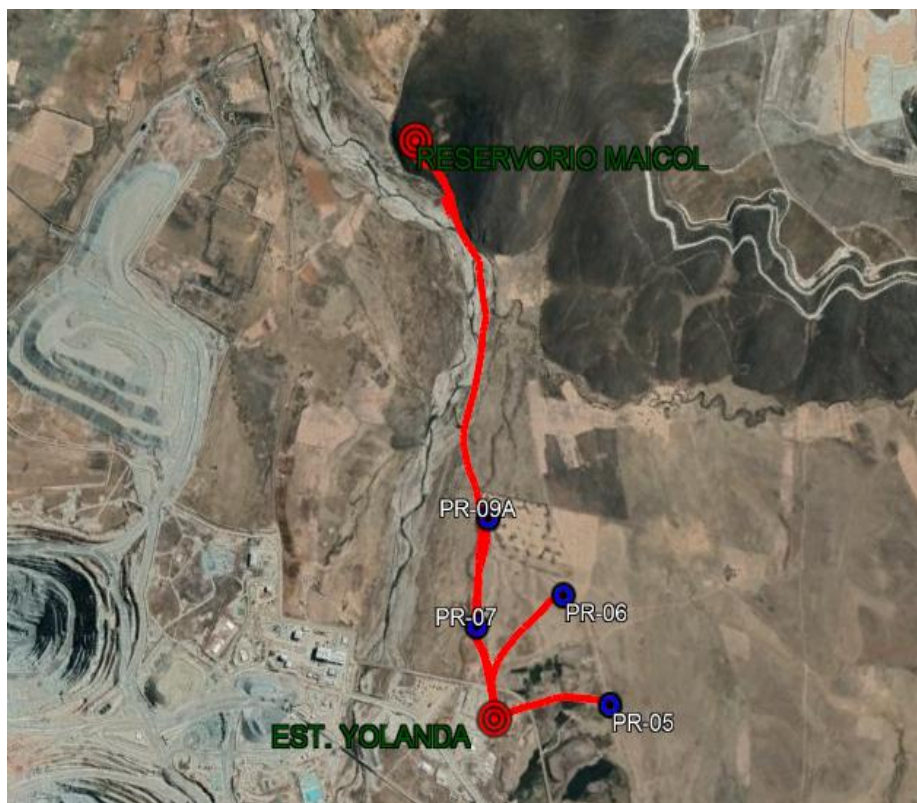
Figura 27: Sistema de reposición de agua Cañipía
