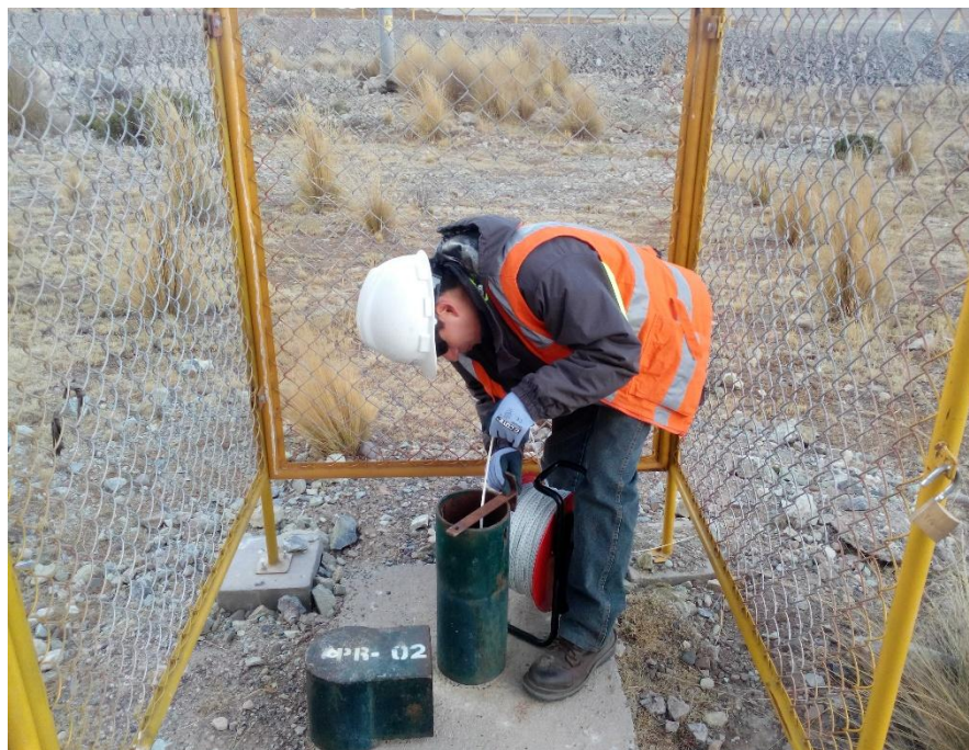
Figura 24: Monitoreo de niveles piezometricos PR-02
