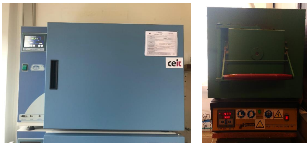
Figura 42: Estufa Selecta Modelo 381 (izquierda) y horno mufla Hobersal (Modelo 12PR/300, serie 8B) (derecha).
