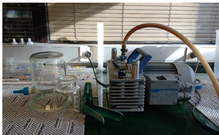
Figura 39: Equipo de filtración y bomba de vacío.
