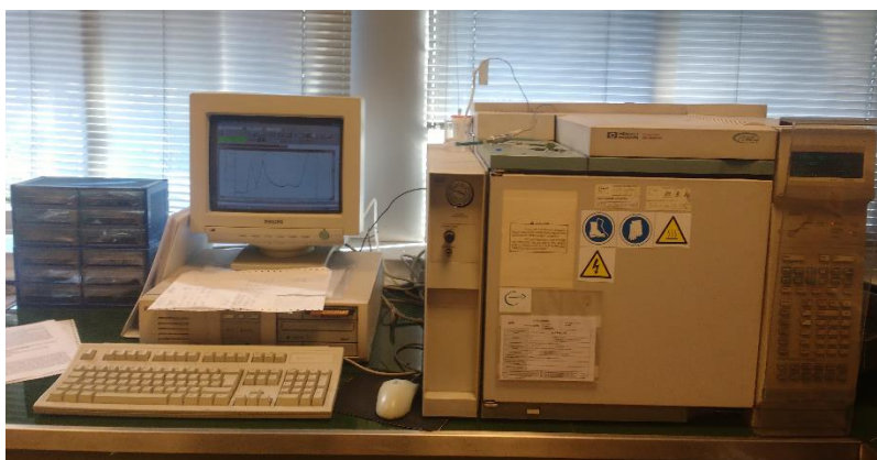
Figura 35: Equipo de cromatografía de gases GC-TCD HP6890 (columna SUPELCO 60/80 Carboxen, Ref. 10001-2390-U).
