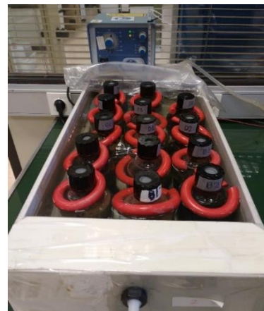
Figura 5: Imagen del montaje de los bioreactores/fermentadores anaerobios de 2 L (imagen izquierda) y 0,5 L (imagen derecha) a escala de laboratorio.
