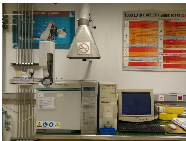
Figura 36: Equipo de cromatografía de gases Agilent GC-6890, equipado con un FID (Flame Ionization Detector) y una columna capilar (DB-FFAP, 30m x 0,25 mm i.d., 0,25 \mu m film, Agilent J&W ref. 122 – 3232E), utilizado en la medición de AGV.
