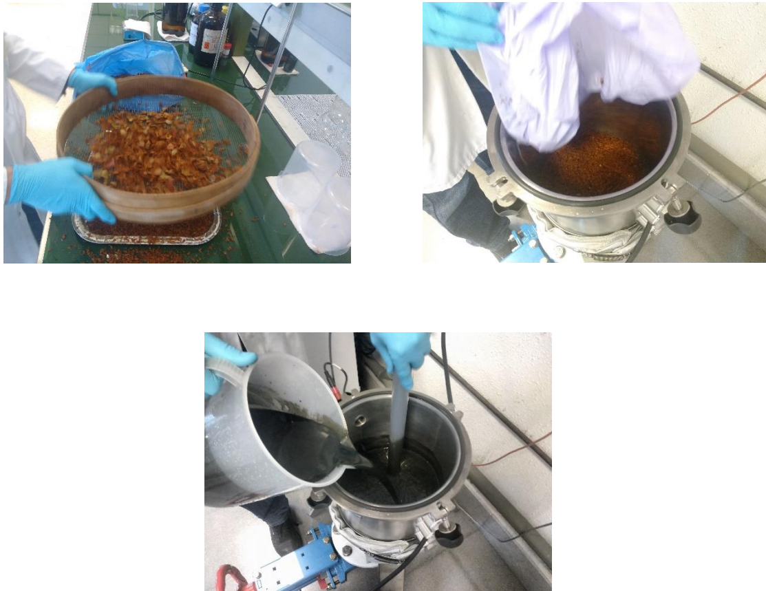
Figura 50: Procesamiento de las muestras (LP+PM) para la fermentación acidogénica a escala piloto.
