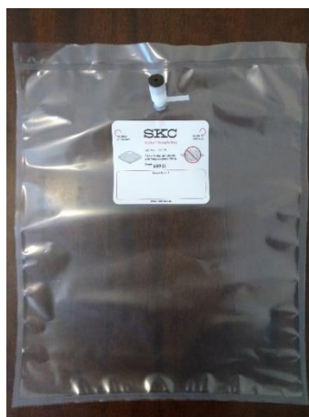
Figura 34: Bolsa Tedlar de 5 L utilizada en la toma de muestra para la composición del biogás en la plataforma piloto.
