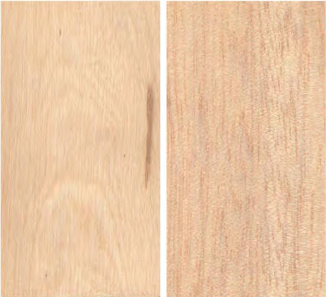
**Figura 16.** Madera en corte tangencial y radial de *Marila tomentosa*
