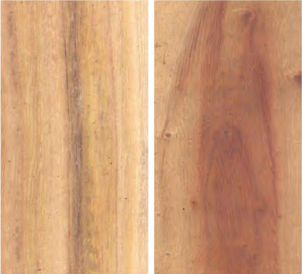
**Figura 11.** Madera en corte tangencial y radial de *Haplorhus peruviana*
