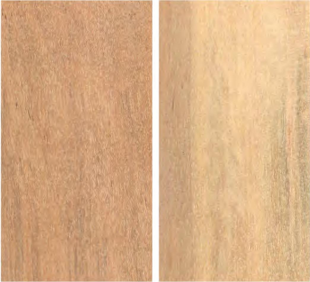
**Figura 1.** Madera en corte tangencial y radial de *Casearia arborea*
