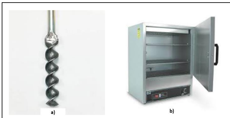
Figura 22: a) Barreno espiral, b) Horno a 105° C de temperatura
