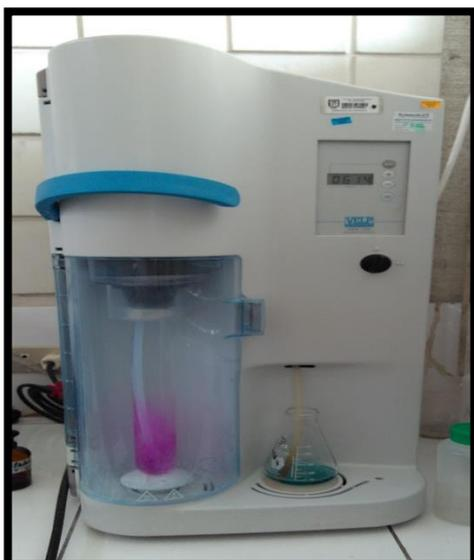
Destilador Kjeldahl para determinar contenido de proteína
