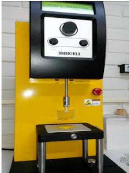
Figura N°3: • Texturómetro de marca Brookfield.CT3-4500
