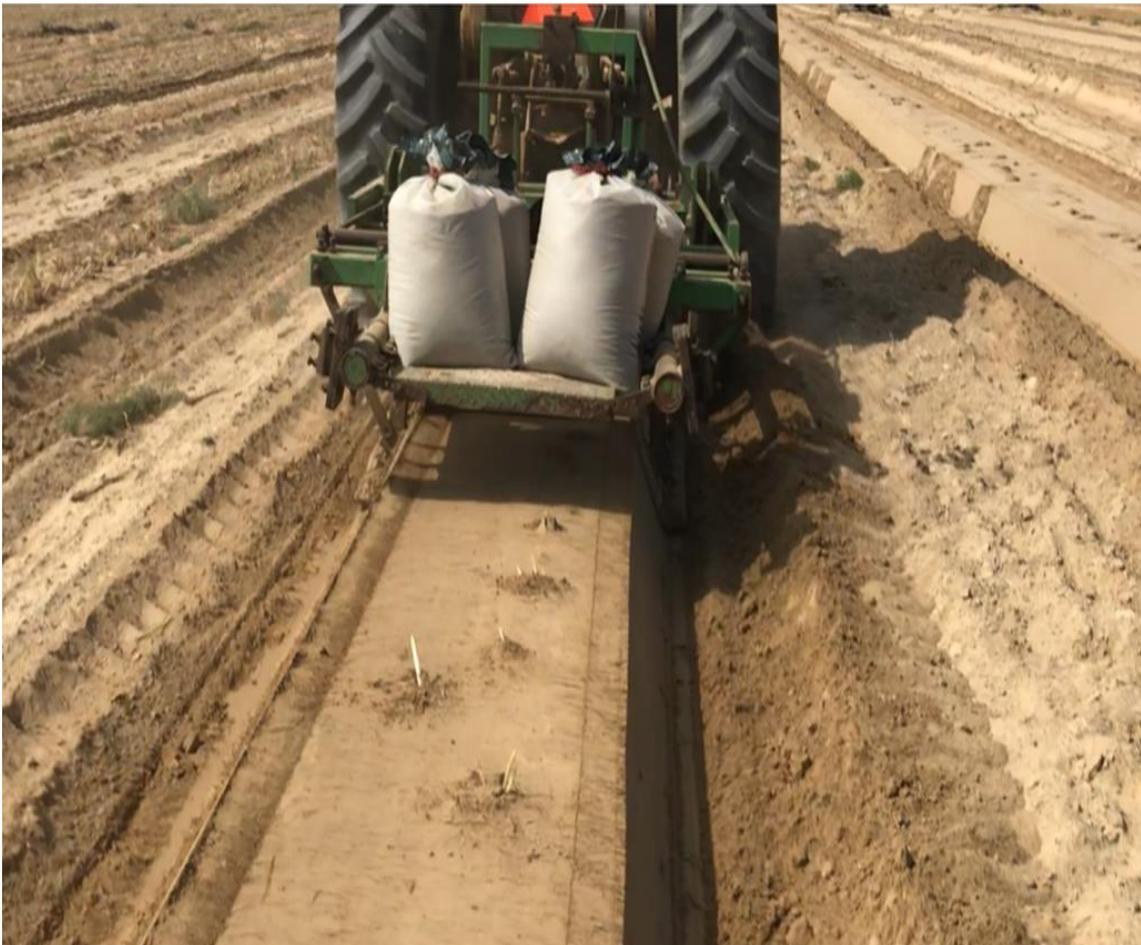
**Figura N°08 Aporque realizado con encamadora**
