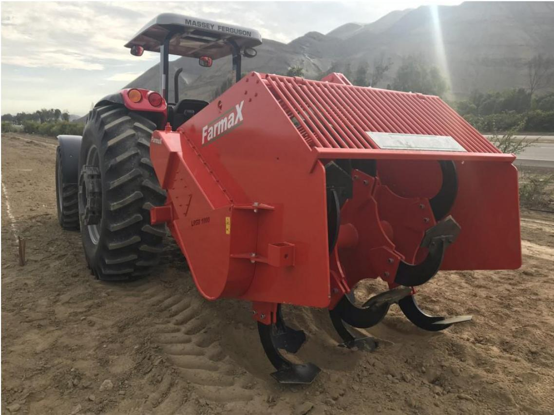
**Figura N°04 Máquina mezcladora de suelo**
