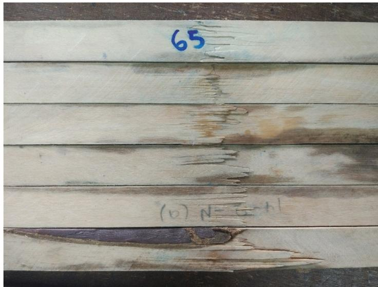
Fallas de probetas en flexión estática
