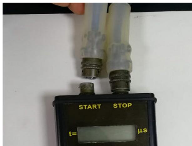
Figura 7: Conexión de los sensores a los conectores *START* y *STOP*.
