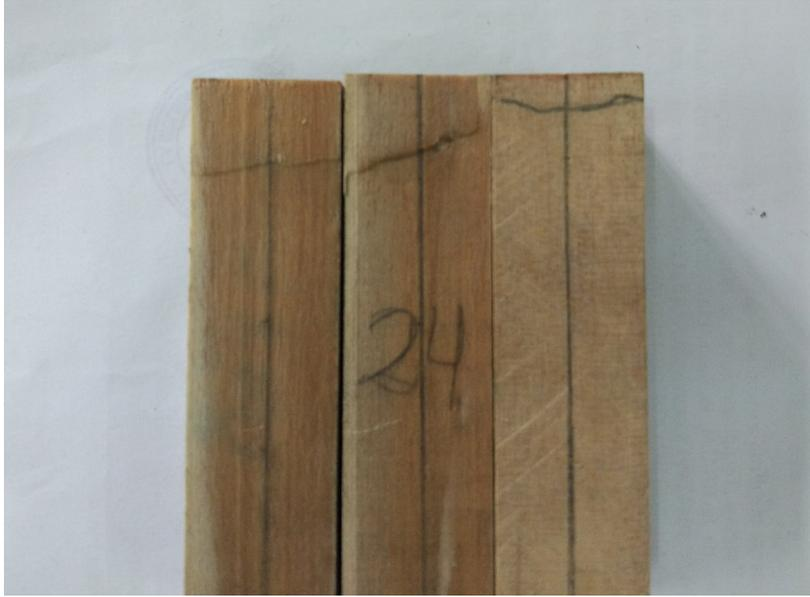
Fallas de probetas en compresión paralela
