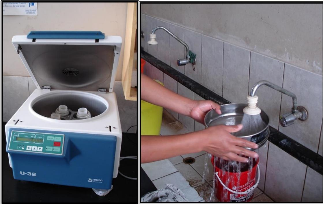
Figura 4: Método de centrifugación en azúcar: centrifugadora y tamizado de suspensiones.
