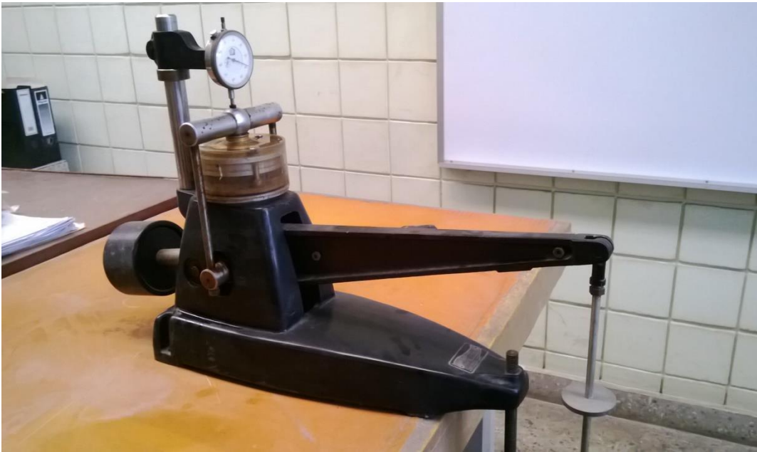
5.8: Extensómetro indicando la lectura de la deformación de la muestra producto de cargas puntuales.
