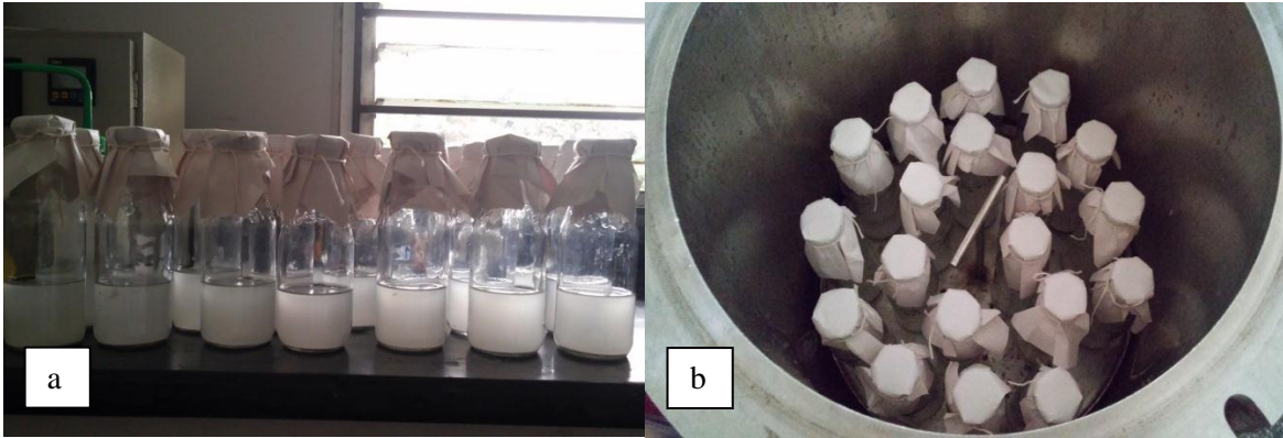
Foto 3: a) Botellas con medio líquido; b) Medios de cultivo a punto de ser esterilizados en el autoclave.
