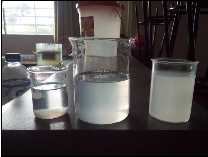
Figura 21: Comparación del agua residual tratada y sin tratar
