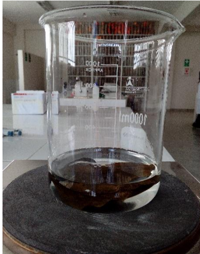
Figura 3: Solución de alcohol e hidróxido de sodio en partes iguales
