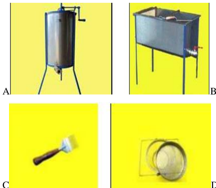
Figura 8 A. Extractor de miel, B. mesa desoperculadora, C. desoperculador y D. filtro de miel
