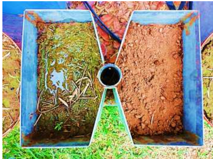
Figura 4: Saturación con agua del suelo contenido en la SDRL (lado izquierdo) del macetero de respuesta hidrogravitrópica selectiva para verificar alguna evidencia de transferencia horizontal de humedad hacia la SDRL opuesta (lado derecho).
