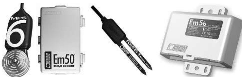
Figura 3.2: Instrumentación (Decagon Devices® USA) para el monitoreo de los parámetros que permitieron la construcción de la curva de retención agua-suelo: sensor para medir el potencial matricial del suelo (MPS-6, kPa) y su data logger Em50; y el sensor EC-5 para monitoreo de la humedad volumétrica del suelo (%) y su data logger Em5b.
