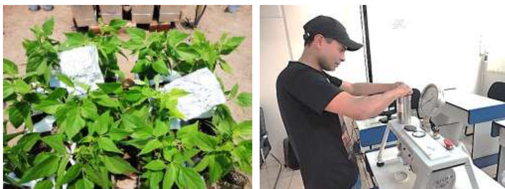
Figura 3.3: Preparación de las hojas en las plantas de frijol común ( Phaseolus vulgaris L.) cultivadas en maceteros de respuesta hidrogravitrópica selectiva (izquierda), para la medición del potencial hídrico xilemático en la bomba Schölander (modelo 3005F01 de Soilmoisture Equipment Corp. Santa Barbara, California-USA) (derecha).
