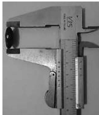
Figura 2: Medición del diámetro en el eje polar de la semilla de frejol común ( Phaseolus vulgaris L.) Var. Red Klaud para el diseño de la cama de germinación en el CGPRL.
