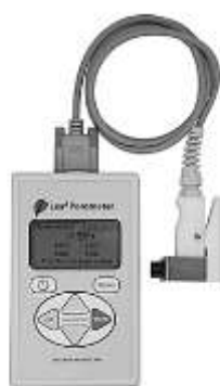
Figura 3.4: Porómetro de estado estacionario SC-1 (Decagon Device USA) (izquierda) para el monitoreo de la conductancia estomática en hojas de plantas de frijol común ( Phaseolus vulgaris L.) cultivadas en los maceteros de respuesta hidrogravitropica selectiva (derecha).
