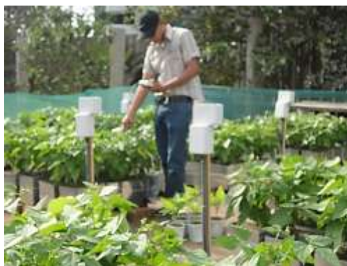
Figura 3.4: Porómetro de estado estacionario SC-1 (Decagon Device USA) (izquierda) para el monitoreo de la conductancia estomática en hojas de plantas de frijol común ( Phaseolus vulgaris L.) cultivadas en los maceteros de respuesta hidrogravitropica selectiva (derecha).
